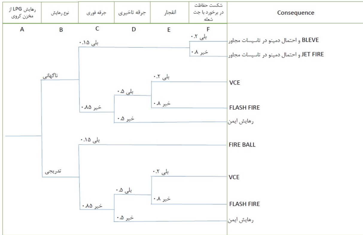
تصویر ۳: درخت رویداد ترسیم‌شده مربوط به رهایش گاز LPG از مخزن کروی در روش Bowti
