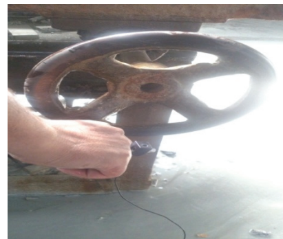
تصویر ۱: اندازه‌گیری ارتعاش دست و بازو در حین کار با دستگاه برش عرضی و برش طولی
